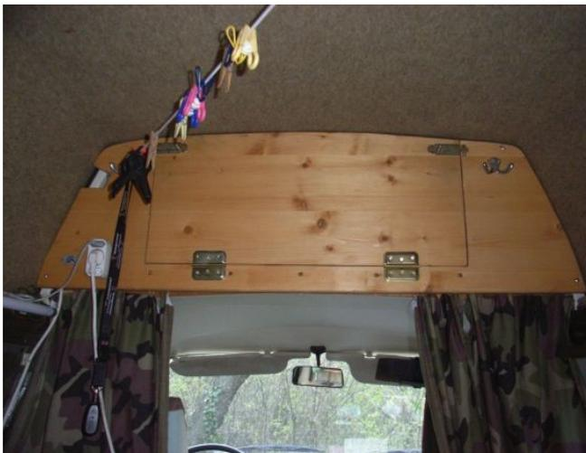
Über dem Fahrerhaus ist ein Brett. Ich habe diese Holzplatte angepasst und ein Türchen hineingeschnitten. Die Abschlussplatte ist an der Platte über dem Fahrerhaus und an dem Dachspiegel angeschraubt.
