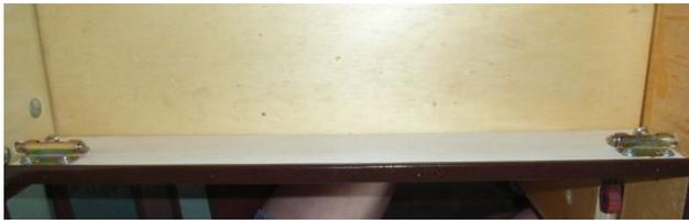
Darüber eine entfernbare Blende (dort liegt erfahrungsgemäß viel herum, das beim Fahren runterfällt;) Befestigung der Blende, seitlich 2 Riegel, an der Unterseite der Blende sind 2 Stifte, die in Löcher in der Platte eingreifen.
