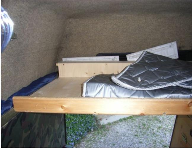
Hinten hab ich auf dem oberen Fahrzeugrahmen eine Holzplatte über die gesamte Fahrzeugbreite aufgelegt, diese geht auch über den Gaskasten.
