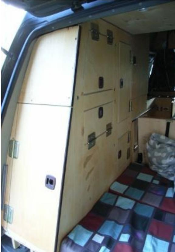
Ganz hinten unten der Gasschrank für 2 Stück 5 kg-Flaschen, Beladung von hinten, auf der Seite eine Bedienungsöffnung.
